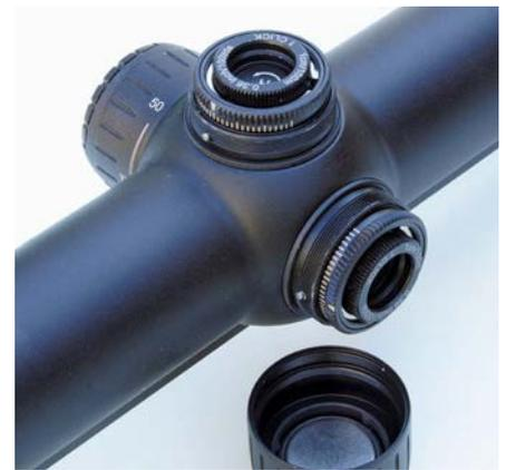
Die Drehscheiben der Absehenverstellung sind flach gehalten. Die Oberseite des Deckels steht nur 17 mm über dem Hauptrohr.
