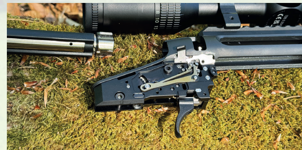
In der Waffe werkelt ein axial in der Länge justierbarer Abzug, dessen Zügel sich somit um 8 mm vor und zurück versetzen lässt.
