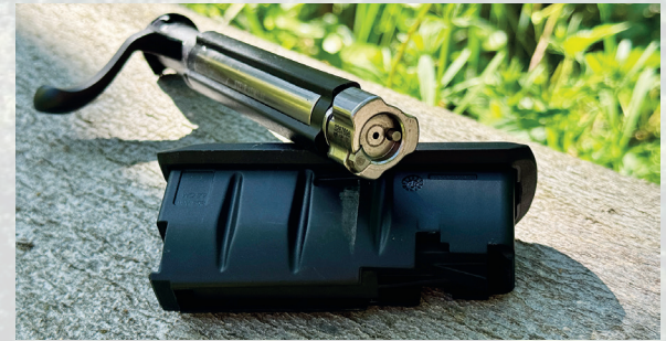
Die Steyr-Büchse verriegelt über einen Dreiwarzen-Verschluss, in der Warze links unten sitzt der Auszieher. Hinten zu sehen ist der Kammerstängel.
