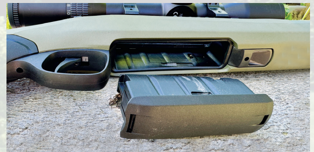
Mitgeliefert war ein für drei Patronen ausgelegtes Kunststoffmagazin, zu entnehmen durch Zug nach hinten an der Taste vor dem Magazinschacht.
