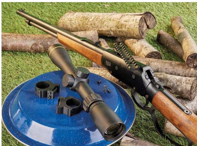
Zum Test bekam die Revel Classic eine Pica-Rail von Savage, zu befestigen mit vier Schrauben. Von Leupold stammten die PRW2-Montageringe und das ZF VX-Freedom Rimfire 2–7 x 33.
