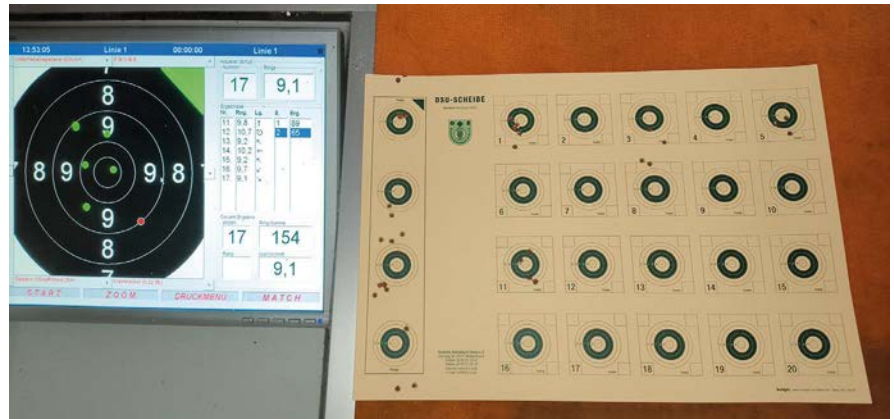
Blick ins Test-Szenario: Links die elektronische Trefferanzeige, rechts die DSU-Scheibe Benchrest KK 50 mit den Schussbildern des Savage-Repetierers Revel Classic.
