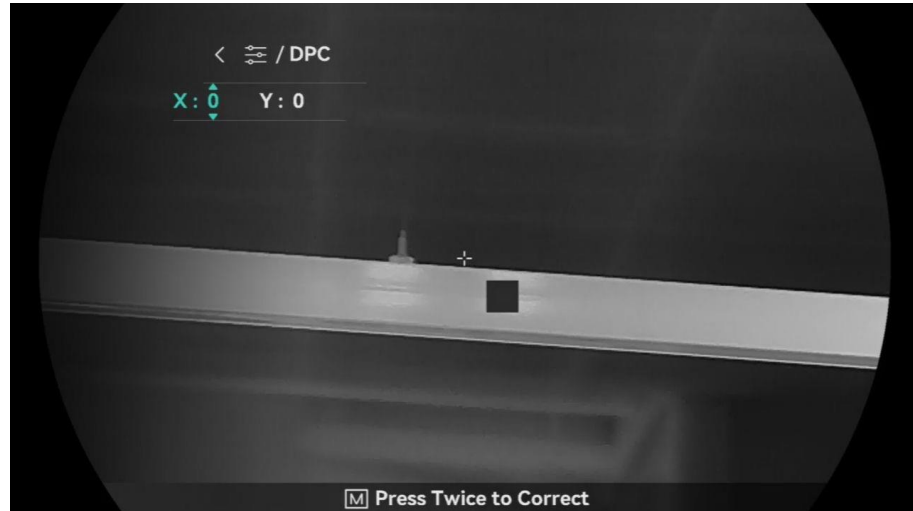
Abbildung 3-6 Defekte Pixel korrigieren
