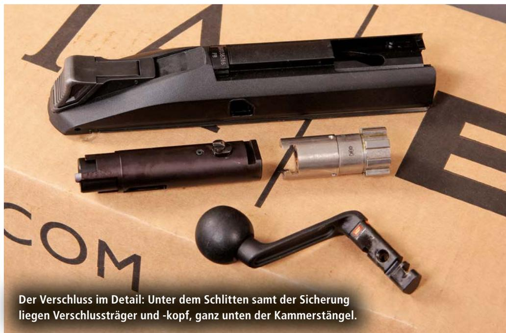
Der Verschluss im Detail: Unter dem Schlitten samt der Sicherung liegen Verschlussträger und -kopf, ganz unten der Kammerstängel.
