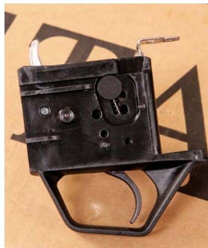
Die Nahaufnahme des ausgebauten Abzugsmoduls, gut zu erkennen ist der Knopf zur Verstellung des Auslösegewichts.
