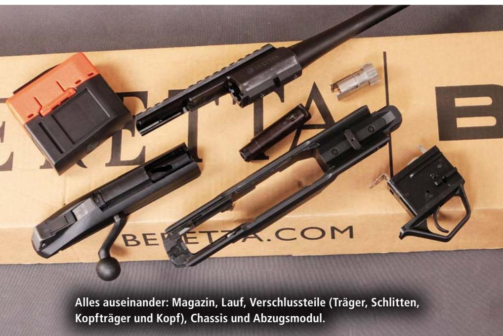
Alles auseinander: Magazin, Lauf, Verschlusssteile (Träger, Schlitten, Kopfträger und Kopf), Chassis und Abzugsmodul.
