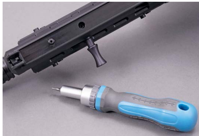
Um den Ladehebel auf der gegenüberliegenden Waffenseite positionieren zu können, muss – GSG-typisch – geschraubt werden.
