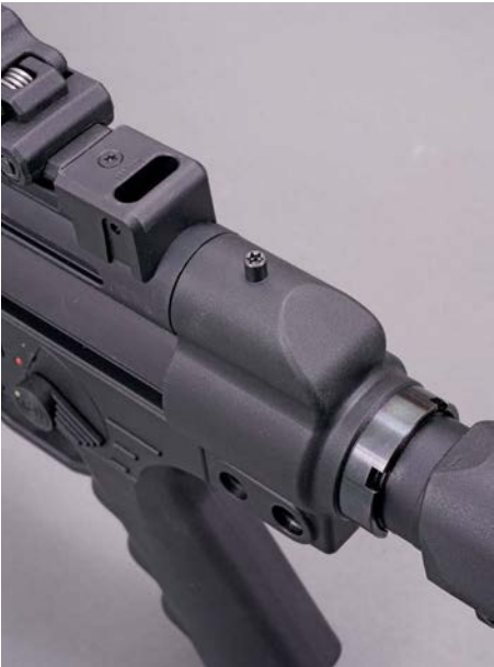
Neben dem Demontagebolzen muss auch noch eine Schraube gelöst werden, wenn man die Schulterstütze vom Gehäuse entfernen möchte.
