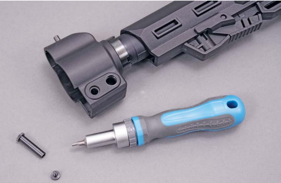
Neben dem Demontagebolzen muss auch noch eine Schraube gelöst werden, wenn man die Schulterstütze vom Gehäuse entfernen möchte.
