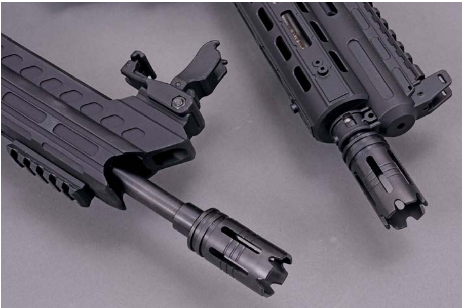
Die lange Sportausführung ist ein Freischwinger, beim kompakten Karabiner berührt der Lauf den Handschutz.
