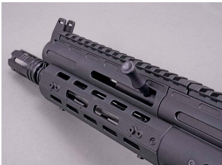
Der Ladehebel kann beidseitig montiert werden.
