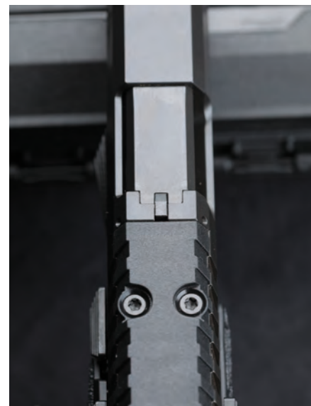
Ein fühl- und sichtbarer Ladestandsanzeiger befindet sich am Stoßboden der ATD-Modelle.
