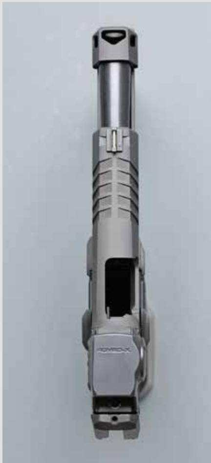
Der Kompensator wird einfach nach der Entfernung eines formschlüssig wirkenden Sicherungsstiftes um 180 Grad gedreht und abgezogen. In Zukunft soll es auch ein Laufgewicht mit gleicher Bauform geben.
