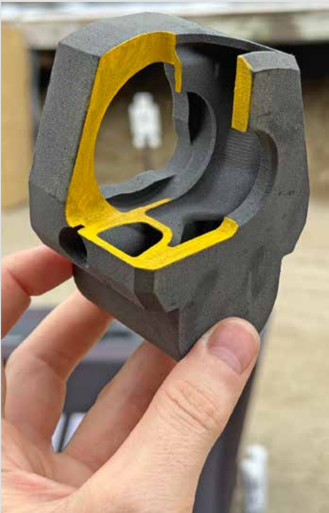
Bei SIG hat man viel Arbeit in die Wirksamkeit des Drei-Kammer-Kompensators gesteckt. Der 3D-Druck kann bei solch geometrisch aufwendigen Konstruktionen ein fertigungstechnischer Segen sein. Das Bild zeigt ein übergroßes Schnittmodell anlässlich der SIG NEXT 2025-Veranstaltung in den USA. (Foto: Carsten Burfeindt)
