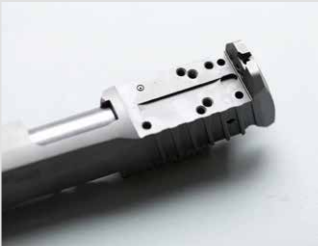
SIG-LOC-Pro heißt die aktuellste Schnittstelle für Leuchtpunktvisiere. Mit drei formschlüssigen und zwei Schraubverbindungen soll sie den ultimativen Halt bei härtester Beanspruchung sichern.
