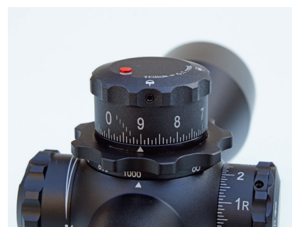
K318i Refined-Höhenjustierturm mit neuer Indexierung, drei 360-Grad-Umdrehungen und Signalstift. Hier der Stift in flacher Position (1. Ebene), 1 mm aus Turmkappe hervorsteht (2. Ebene) und 2 mm hervorsteht mit zusätzlich sichtbarem, weißem Ring (3. Ebene).
