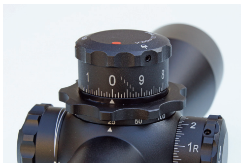
K318i Refined-Höhenjustierturm mit neuer Indexierung, drei 360-Grad-Umdrehungen und Signalstift. Hier der Stift in flacher Position (1. Ebene), 1 mm aus Turmkappe hervorsteht (2. Ebene) und 2 mm hervorsteht mit zusätzlich sichtbarem, weißem Ring (3. Ebene).
