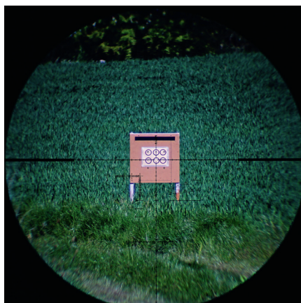
Bei 10-facher Vergrößerung und üppigen 3,75 Meter Sehfeld auf 100 m sieht man den feinen 3,5-mm-Zielpunkt im Zentrum deutlich.
