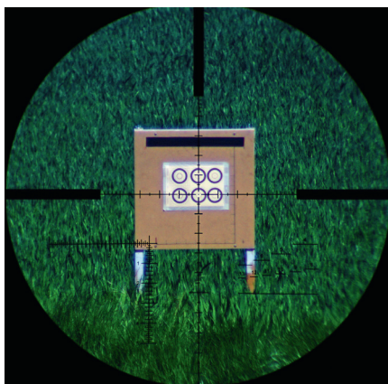
Die massiven Balken des alten MSR-Absehens verdecken viel vom Zielbild.
