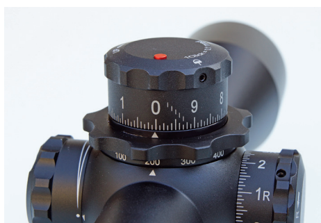
K318i Refined-Höhenjustierturm mit neuer Indexierung, drei 360-Grad-Umdrehungen und Signalstift. Hier der Stift in flacher Position (1. Ebene), 1 mm aus Turmkappe hervorsteht (2. Ebene) und 2 mm hervorsteht mit zusätzlich sichtbarem, weißem Ring (3. Ebene).
