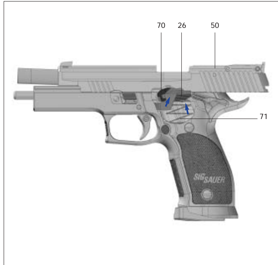
Abb. 22, Verschluss bleibt bei leerem Magazin in offener Stellung gefangen
