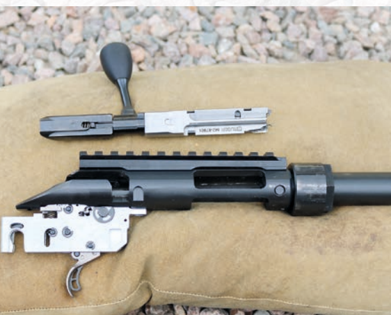
Das ausgeschüttete Systemgehäuse mit Abzugsgruppe, darüber der Zylinderverschluss der Precision Rimfire.
