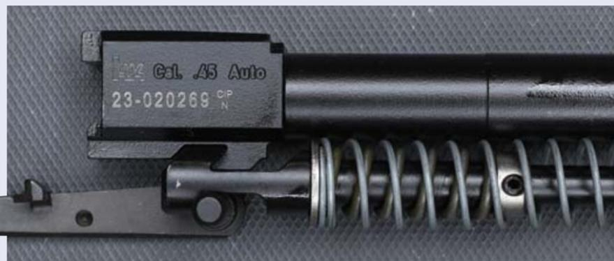
Erstmalig in der SOCOM-Pistole, später auch in der USP: Die längsverschiebbare Federführungsstange mit den zwei nacheinander wirkenden Verschlussfedern. Der rund 5 mm lange Weg, den die Federführungsstange abgestützt auf dem Verschlussfanghebel nutzen kann, soll den Entriegelungsstoß reduzieren, das Material schonen und ein angenehmeres Rückstoßverhalten liefern.
