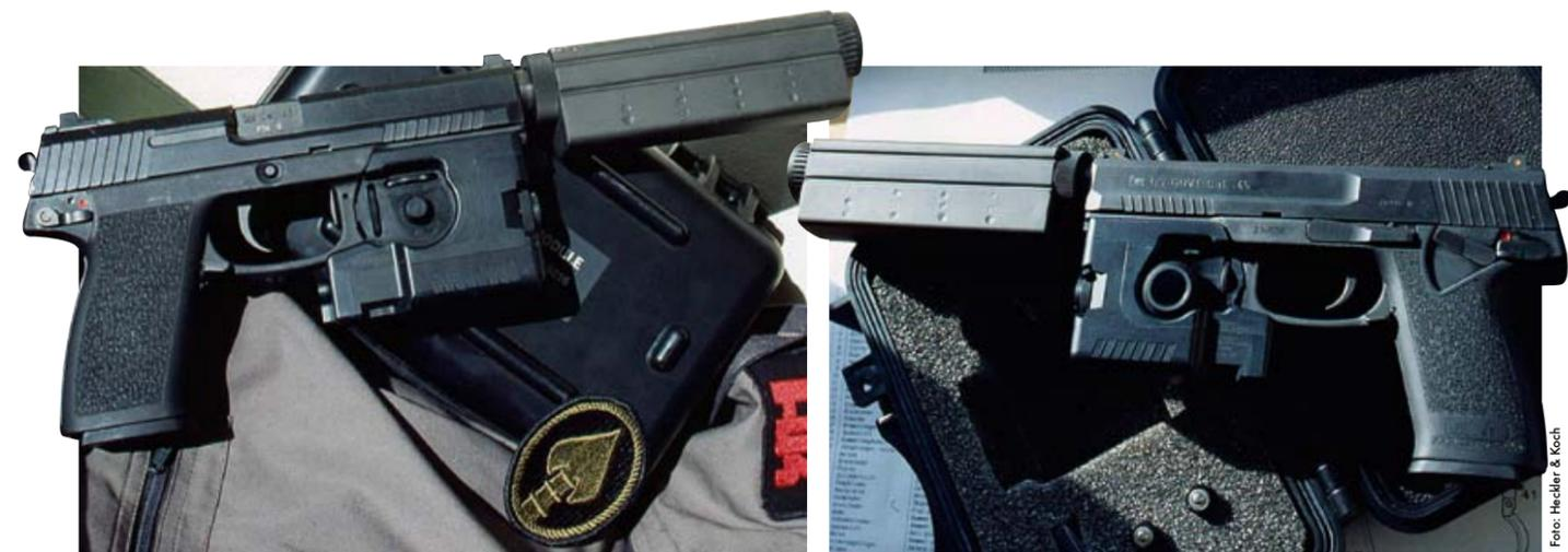
Was für ein Koffer: Mit Schalldämpfer und Laser-Licht-Modul brachte es die SOCOM-Pistole auf satte 2,5 kg. Hier noch die erste Ausführung mit der Verschlussperre im vorderen Bereich des Abzugsbügels, der in die darüber liegenden Aussparungen des Verschlusses greift.
