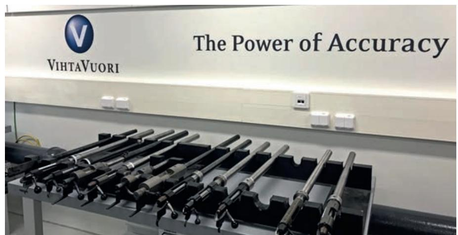
**Einige Testläufe mit zum Teil Standard-Verschlussystemen. Alle sind mit einer Aufnahme für den Piezosensor versehen.**
