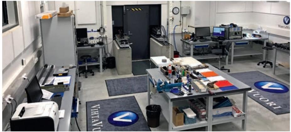
**Im Versuchslabor. Hier werden die Testpatronen geladen und Druck- und Geschwindigkeitsmessungen durchgeführt. In einem Nebenraum sind Geräte wie eine manometrische Bombe aufgestellt. Vor der schwarzen Türe sind die zwei Testmaschinen auf Betonsockel montiert.**
